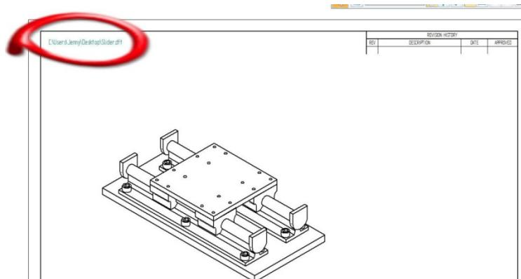
下次要出工程圖時，工程圖範本直接選這份即可，方便在圖上直接看到此零組件的路徑帶來大的方便。…(完)
